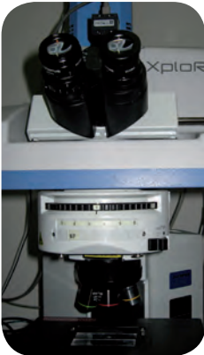
Das neue Mikro-Raman-Spektrometer der Mineralogischen Staatssammlung
