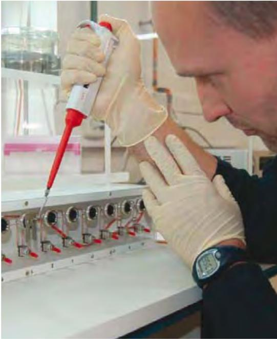
*Proben-Beschickung (oben) und Messung (unten) am neuen Thermionen-Massenspektrometer.*
